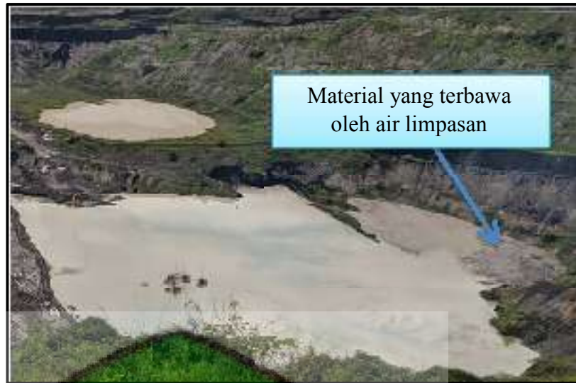
Gambar 4.2 Kondisi Sump Pada Pit M
